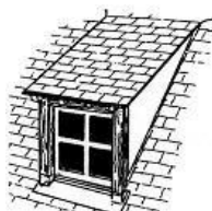
lucarne rampante ou en chien couché
